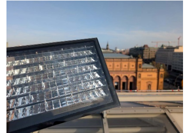
Muster der Isolierverglasung mit innenliegendem dreidimensionalen Sonnenschutzraster auf dem Dach der Galerie der Gegenwart © Hamburger Kunsthalle Foto: Ralf Suerbaum
